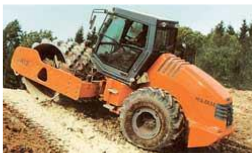
Рис. 9.1.8 – Кулачковый виброкаток 3412 фирмы НАММ на уплотнении откоса
